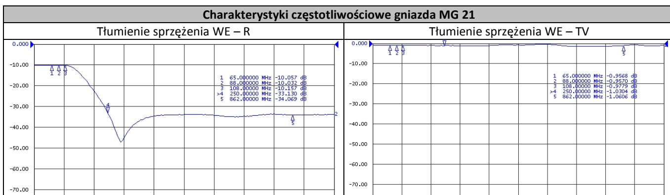
PARAMETRY TECHNICZNE GNIAZD KOŃCOWYCH MG 21 (kolor etykiety : jasnoszary)
