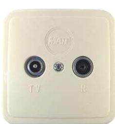
**Gniazda GMK 1** przeznaczone są do zakończenia wyprowadzeń abonenckich w antenowych sieciach gwiaździstych (przyłączach równoległych) lub odgałęźnych. Gniazda serii M (GM.., KM..) są gniazdami typu zwrotnicowego, wnoszone tłumienie sprzężenia w tor TV jest więc minimalne. Polecane są zarówno do systemów TV kablowej, instalacji zbiorczych jak i indywidualnych instalacji antenowych.
